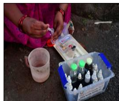
चित्र 5.1: जल परीक्षण के लिये निगरानी समूह के सदस्य द्वारा फील्ड टेस्ट किट का उपयोग
