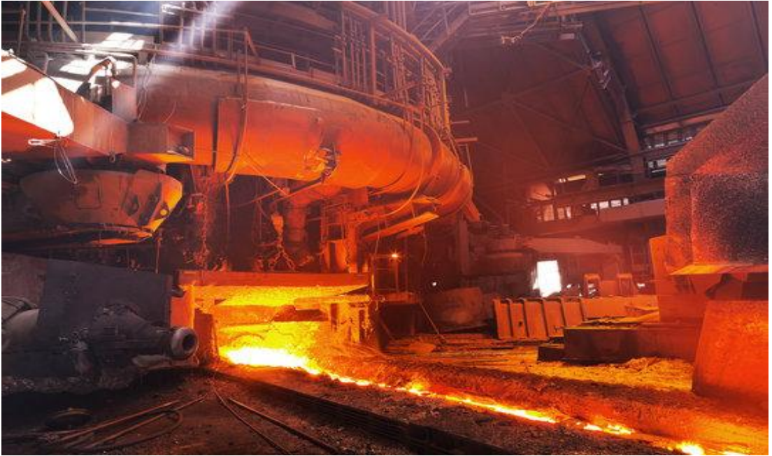
चित्र 6: भिलाई स्टील प्लांट के ब्लास्ट फर्नेस #8 से मुख्य गर्त से बहने वाला तप्त धातु
