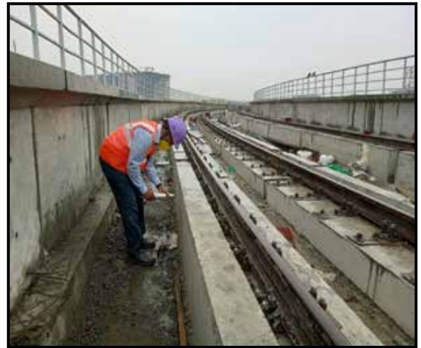
चित्र 7 - सेंट्रल सिल्क बोर्ड स्टेशन पर रिबाउंड हैमर का परीक्षण
